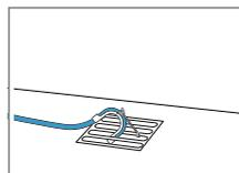
Spostare completamente il tubo flessibile di scarico dell'acqua attraverso il collettore e fissare con il materiale apposito.
