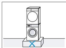
Installare questo apparecchio in una colonna lavatrice-asciugatrice soltanto con il set di collegamento originale del produttore dell'asciugatrice. → "Accessori", Pagina 28
